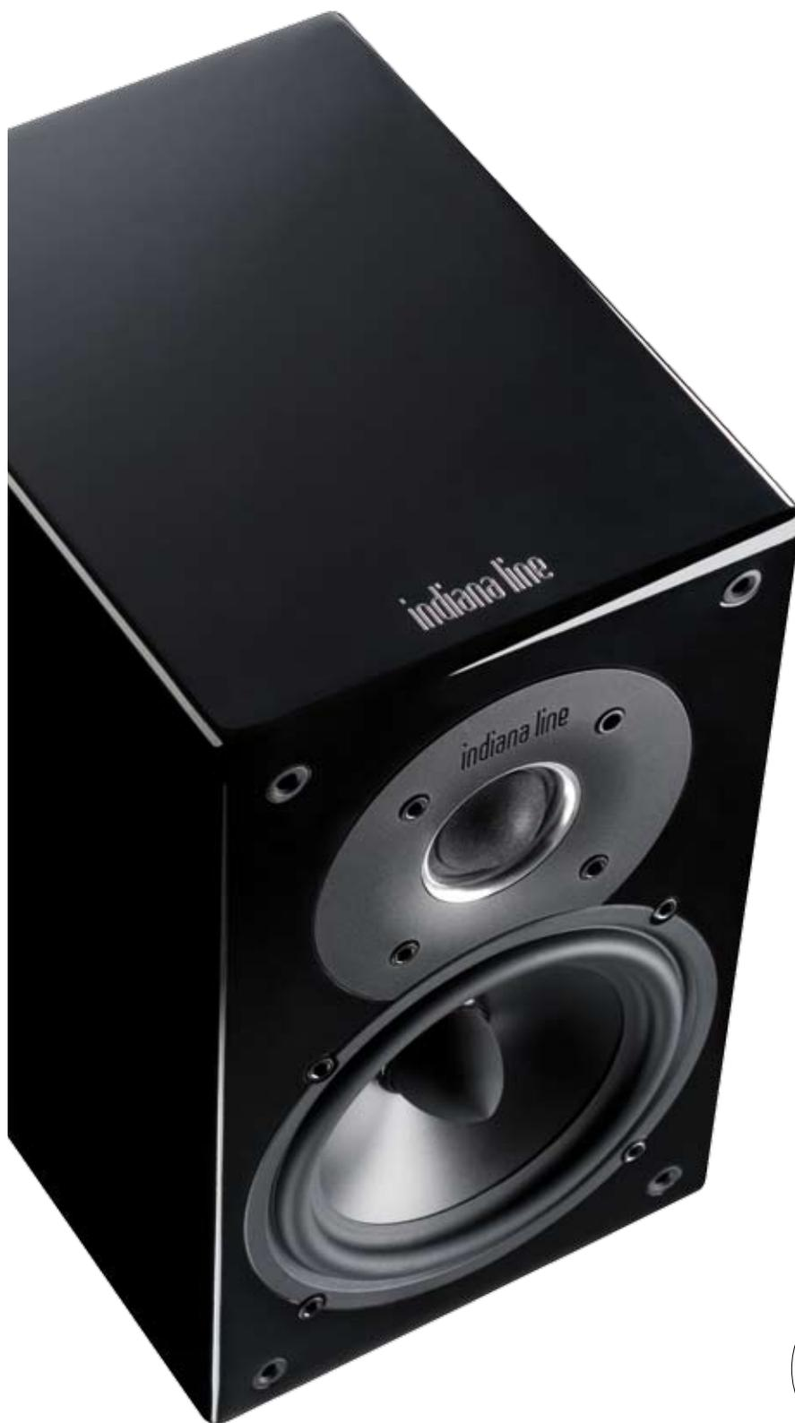
Tesi 242 è un compatto diffusore da scaffale, caratterizzato dalla invidiabile definizione e naturalezza nella riproduzione della voce, con una risposta ai transienti veloce e molto precisa. I woofer utilizzano coni in polipropilene rinforzato con mica e sono dotati di rifasatori centrali per migliorare risposta e dispersione alle medie frequenze. I tweeter utilizzano cupole di seta molto leggera, potenti magneti al neodimio ed un'esclusiva camera di risonanza posteriore.
